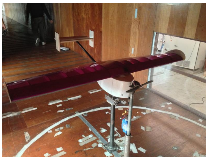
Figura 14 - Instalação do modelo no túnel de vento do IPT
